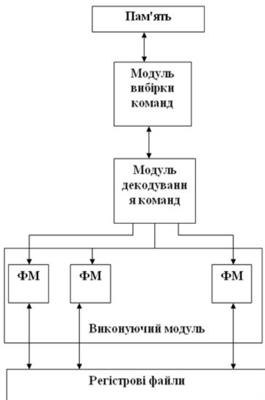
Мал.1.11. Схема процесора з наддовгим командним словом
