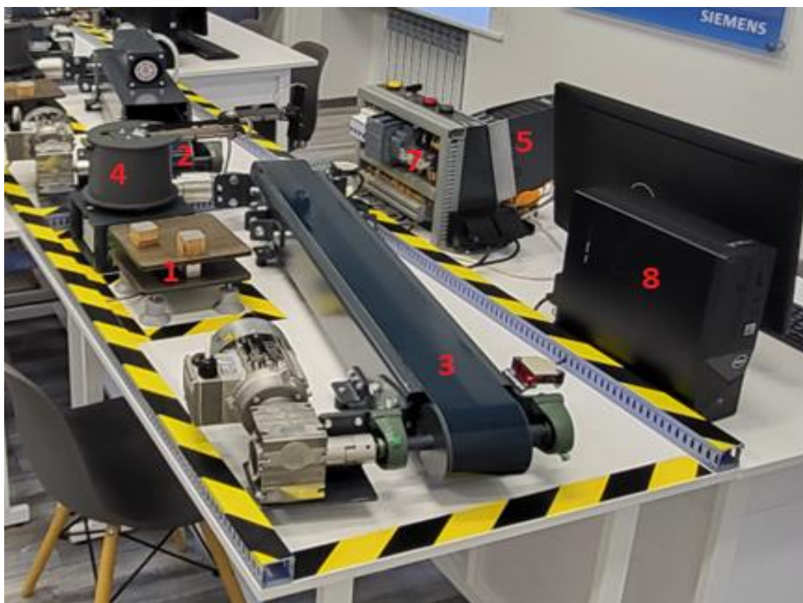
Рис. 1. Обладнання стенду-макету ділянки сортування: 1 – терези; 2 – конвеєр сусіднього стенду; 3 – конвеєр поточного стенду; 4 – робот-маніпулятор; 5 – перетворювач частоти; 7 – комплект контролера; 8 – автоматизоване робоче місце; 9 – кнопка протиаварійного захисту
