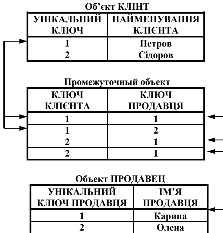
Рис. 7 Відображення взаємозв'язку між даними при відношенні "багато хто до багатьох" за допомогою проміжного об'єкта
